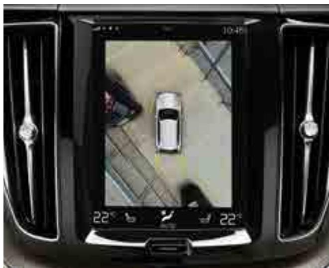
**Камера кругового обзора 360°.** С этой опцией водитель может на центральном дисплее увидеть автомобиль словно с высоты птичьего полета, что очень удобно и безопасно особенно при парковке или маневрировании в ограниченном пространстве.
