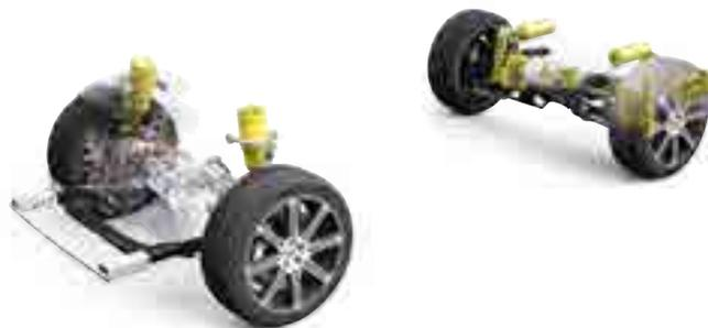
Пневматическая подвеска на всех 4 колесах XC60 выводит комфорт от вождения на новый уровень – пневмобаллоны сглаживают несовершенства дорог и обеспечивают стабильность автомобиля, сохраняя постоянную высоту вне зависимости от нагрузок. С активным шасси вы можете изменить режим езды и управления автомобилем в соответствии с вашим настроением или типом покрытия.
