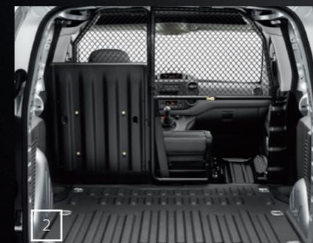
**2.** Сплошная съемная перегородка в половину высоты с решеткой и съемным люком, который позволяет максимально увеличить полезную длину правой части грузового отсека автомобиля при складывании сиденья Multiflex\*.
