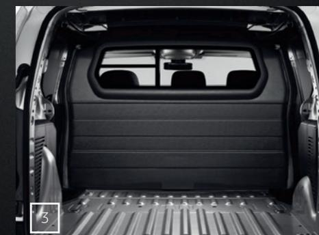
**3.** Перегородка цельнометаллическая с окном и улучшенной шумоизоляцией.
