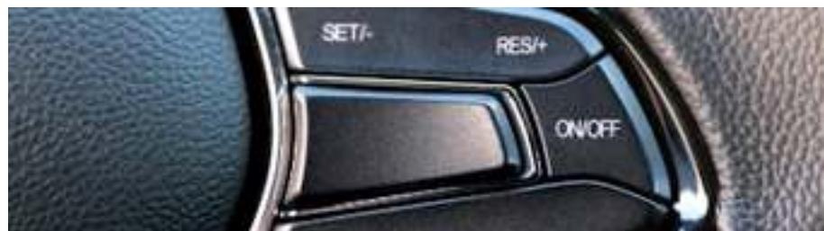
Система круиз контроля позволяет автоматически поддерживать заданную водителем скорость в широком диапазоне - от 40 до 130 км/час. Важно отметить, что указанной системой оснащаются автомобили не только с автоматической трансмиссией, но и с механической коробкой передач. Наличие такой системы несомненно повышает комфорт и безопасность движения.
