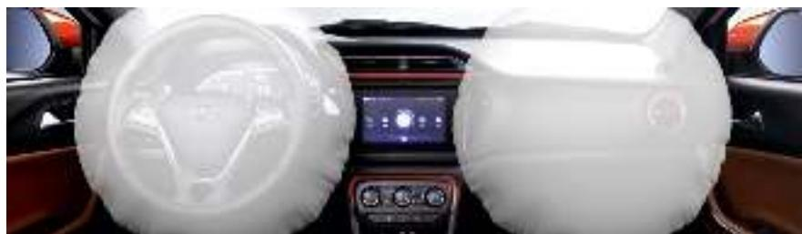
Система пассивной безопасности включает в себя фронтальные подушки водителя и пассажира, трехточечные ремни безопасности с преднатяжителями и подголовники для всех пассажиров. Сочетание указанных элементов обеспечивает, при авариях, высокий уровень защиты пассажиров от различных травм иувений.
