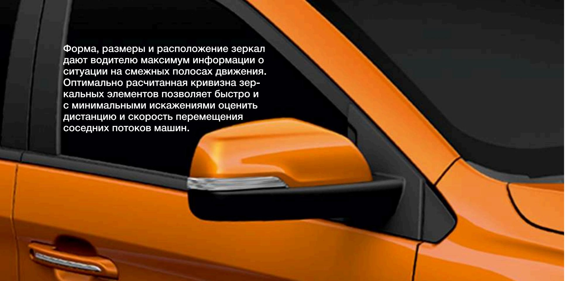
Форма, размеры и расположение зеркал дают водителю максимум информации о ситуации на смежных полосах движения. Оптимально расчитанная кривизна зеркальных элементов позволяет быстро и с минимальными искажениями оценить дистанцию и скорость перемещения соседних потоков машин.
