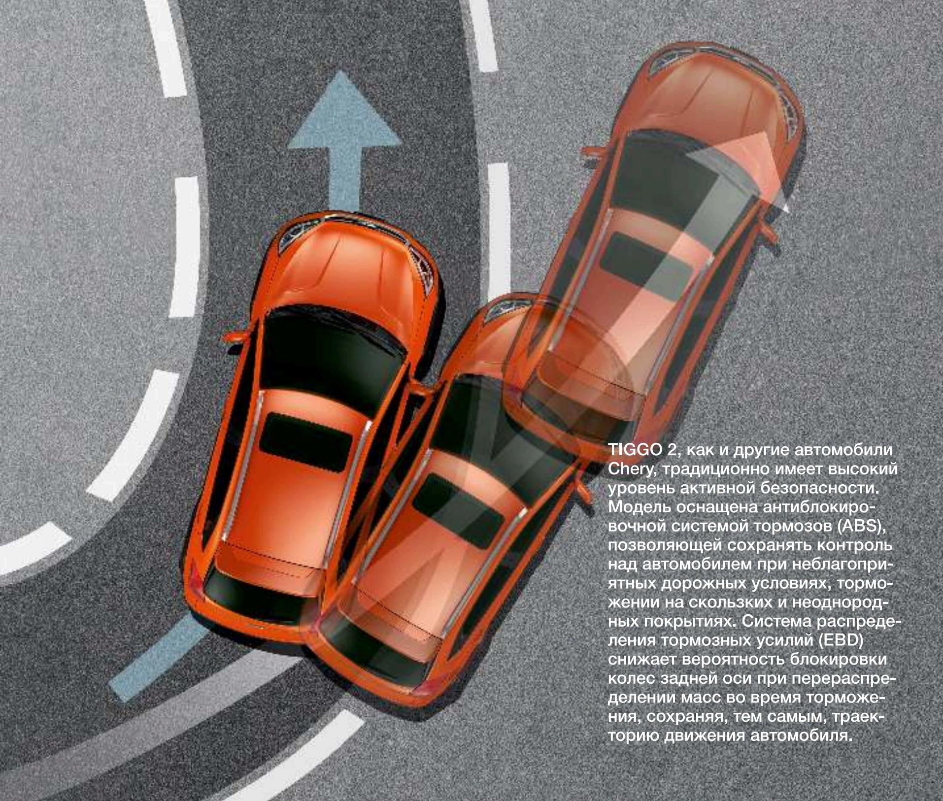
TIGGO 2, как и другие автомобили Chery, традиционно имеет высокий уровень активной безопасности. Модель оснащена антиблокировочной системой тормозов (ABS), позволяющей сохранять контроль над автомобилем при неблагоприятных дорожных условиях, торможении на скользких и неоднородных покрытиях. Система распределения тормозных усилий (EBD) снижает вероятность блокировки колес задней оси при перераспределении масс во время торможения, сохранив, тем самым, траекторию движения автомобиля.
